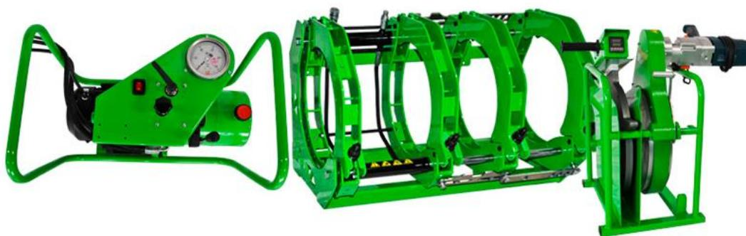
**Центратор четырехзахжимный** - предназначен для центрирования и выравнивания торцов труб и соединительных деталей. Состоит из стальной рамы, пары подвижных хомутов, приводимых в движение гидравлическими цилиндрами и пары неподвижных хомутов. Диаметр свариваемых труб от 75 мм до 315 мм
