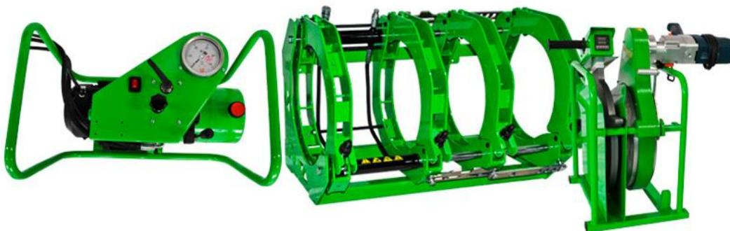
**Центратор четырехзажимный** - предназначен для центрирования и выравнивания торцов труб и соединительных деталей. Состоит из стальной рамы, пары подвижных хомутов, приводимых в движение гидравлическими цилиндрами и пары неподвижных хомутов. Диаметр свариваемых труб от 40 мм до 160 мм. Габаритные размеры 790x390x350мм. Вес центратора 45 кг.
